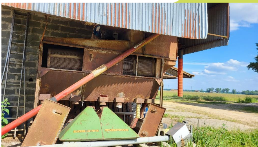
Trieur rotatif DENIS avec plusieurs grilles auto-construites
