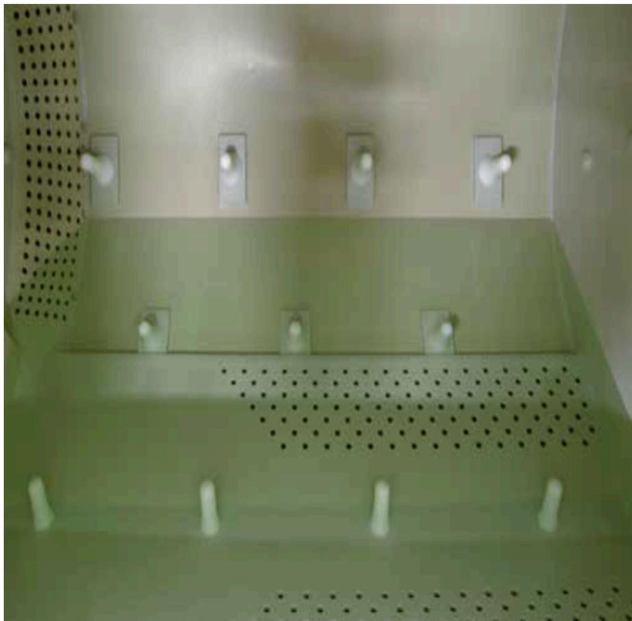
*Cette photo montre l'intérieur d'un foulon. Les quilles, sortes de doigts, permettent d'étirer la peau lors de sa rotation : elle reçoit alors plus de travail mécanique et devient plus souple. Le foulon est aussi doté d'un double fond qui permet l'ajout de produits chimiques sans qu'ils soient en contact directement avec les peaux, au risque de les brûler.*
